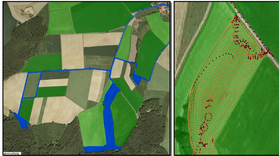
Abbildung 1: Mit Informationen aus der automatischen Prozessdatenerfassung lassen sich sowohl der Verlauf von Arbeiten (links) als auch der genaue Ablauf von einzelnen Maßnahmen, wie z.B. anhand der Hubwerkposition Ort und Dauer von Wendemanövern (rechts) rekonstruieren.
